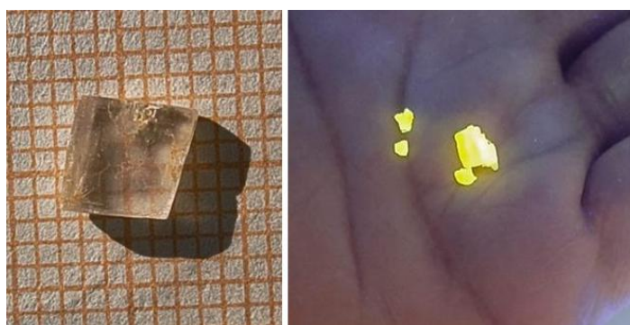
Rys. 1. Kryształ hybrydowy CsI (Fluorofor) jako nowej generacji materiał do budowy scyntylatorów (po lewej) Fluorescencja kryształu po naświetleniu promieniowaniem UV 254nm (po prawej).
